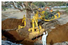
TPM機械による移植作業
