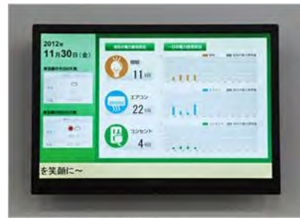
各フロアのエネルギー管理モニター
