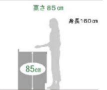
ワークトップのおすすめの高さは、 身長(cm)÷2+5cmが目安です。
